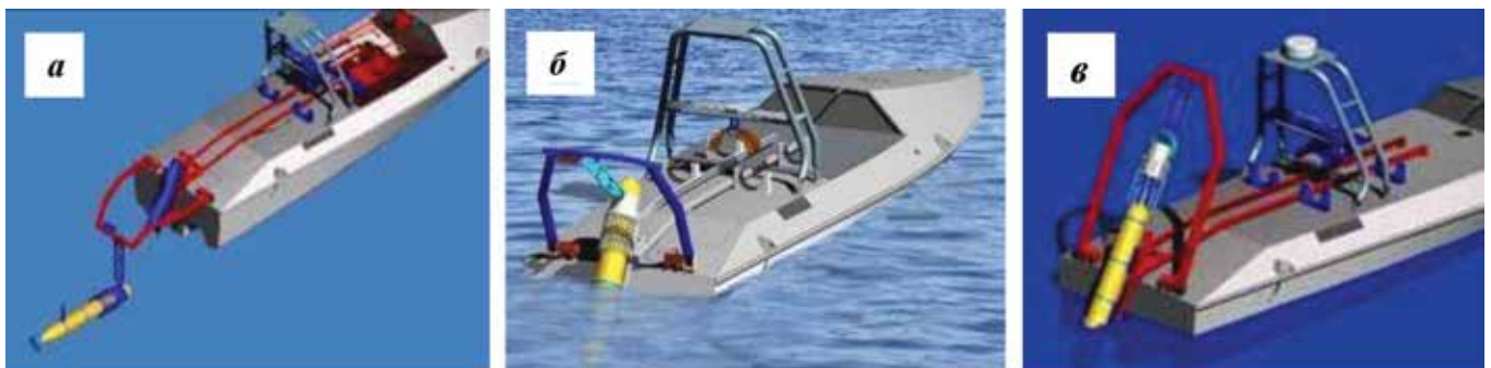
Рис. 2. Схема работы СПУ компании Bluefin Robotics Corp. Ltd:
