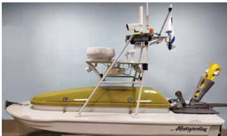
Рис. 10. БЭК «Макаровец» со спускоподъемным устройством и АНПА в положении «по-походному»
