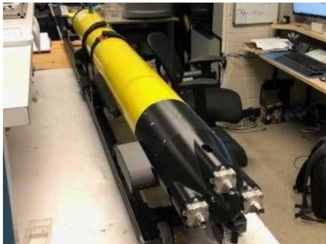
Исследователи из Технологического института Вирджинии (Center for Marine Robotics at Virginia Tech) разрабатывают методы по изучению концентрации микропластика в водной среде и собираются применять АНПА типа «690» в Чесапикском заливе. Аппараты типа 690 - 6,9 дюймов (17,5 см) в диаметре имеют вес примерно 43 кг и могут работать на глубинах до 500 м. Первые тесты полезной нагрузки «microplastics sampler» были проведены на озере Клейтор в 2022 году, а разработка носителя «690» ведется с 2014 г.
