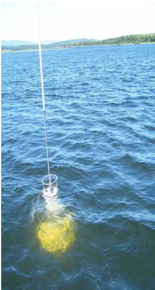
Рис. 3. Морская автономная измерительная платформа на поверхности моря в момент передачи измерительной информации
