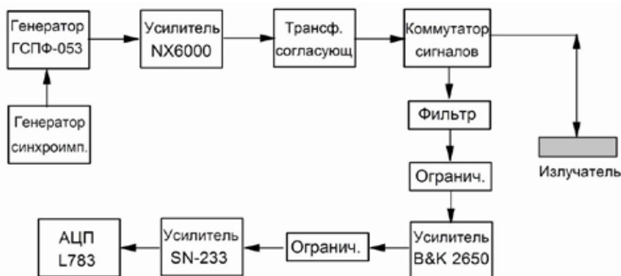
Рис. 1. Функциональная схема аппаратного комплекса для измерения рассеяния звука на различных частотах
