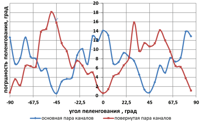
Рис. 4. Угловая зависимость ошибки пеленгования комбинированного приемником с двумя парами ортогональных горизонтальных каналов при отношении сигнал/шум q=6 дБ
