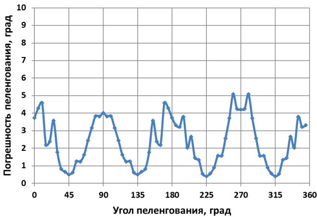
Рис. 2. Угловая зависимость ошибки пеленгования комбинированного приемника с одной парой горизонтальных каналов при отношении сигнал/шум q=16 дБ
