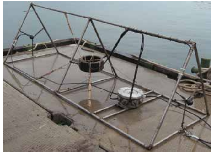
Рис. 4. Акустический интерферометр с двумя крайними приёмными элементами и центральным приёмоизлучающим
