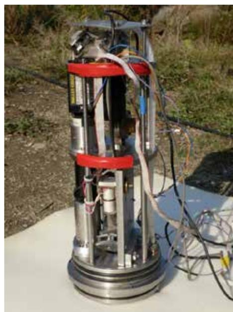
Рис. 1. Внутренний вид сверхчувствительного сенсора вариаций гидросферного давления
