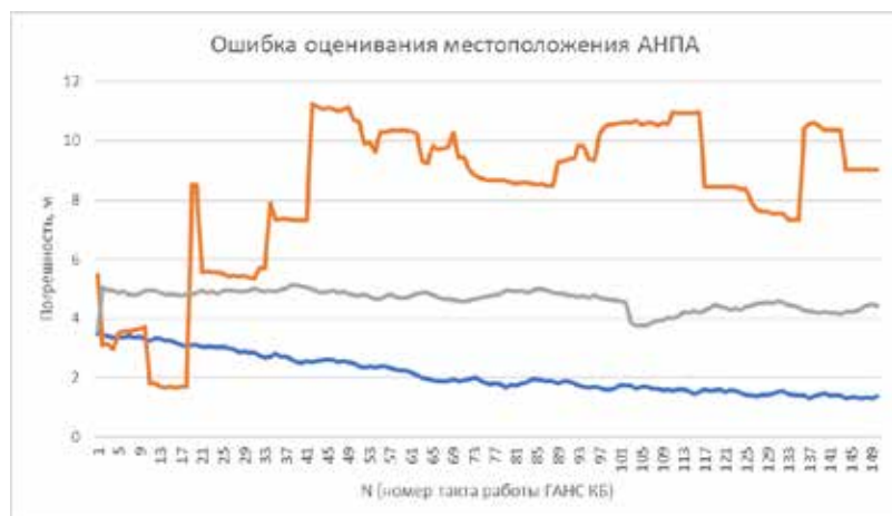
Рис. 3. Ошибки оценивания местоположения АНПА: серая кривая – при использовании рассогласования измеренной и вычисленной разности времени прихода сигналов в двух последовательных тактах ГАНС КБ на одну антенну, оранжевая кривая – при использовании аналогичного рассогласования в одном такте на разные антенны, синяя кривая – при одновременном использовании двух указанных выше рассогласований, полученные при одинаковых уровнях ошибок измерений курса и времени прихода сигнала на антенны АНПА
