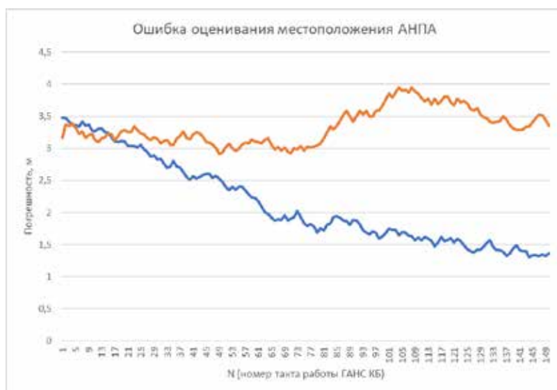
Рис. 4. Ошибки оценивания местоположения АНПА: синяя кривая – при ошибках в измерениях разности времен прихода сигналов, лежащих в диапазоне (-0,3*10^{-4}, 0,3*10^{-4}) секунд и ошибках измерения курса - в диапазоне (-0,1, 0,1) градусов, оранжевая кривая – при ошибках в измерениях разности времен прихода сигналов, лежащих в диапазоне (-10^{-3}, 10^{-3}) секунд и ошибках измерения курса – в диапазоне (-1, 1) градусов
