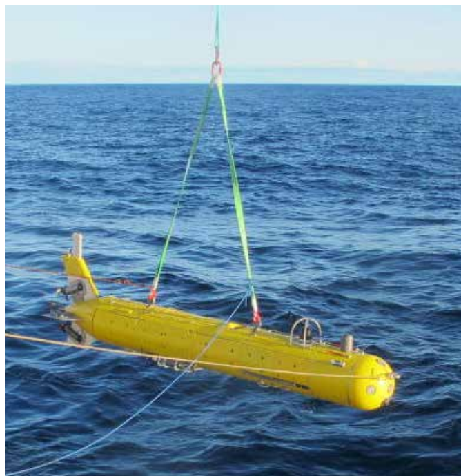
Рис. 15. АНПА ММТ-3500 во время работ в Антарктике
