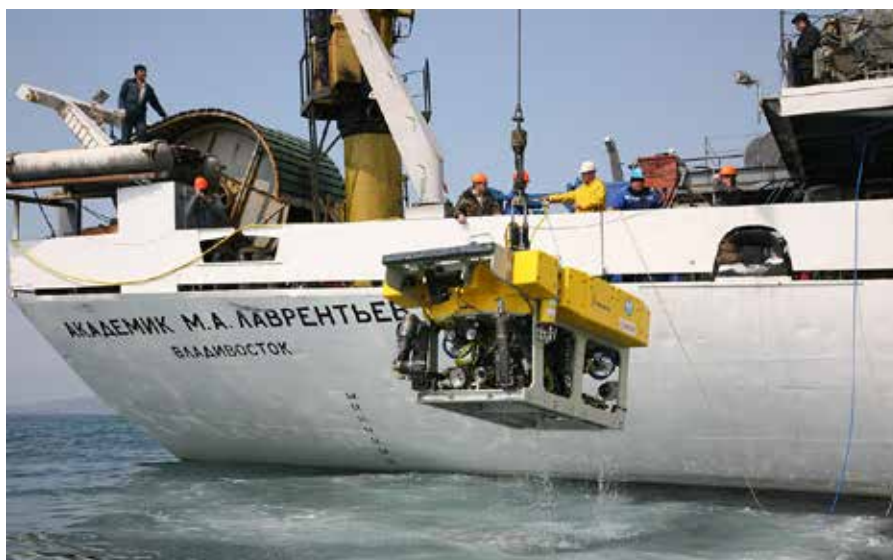
Рис. 8. ТНПА Comanche 18. Рабочая глубина 6000 м. Количество двигателей: 7 электродвигателей тягой по 100 кгс. Манипуляторы: 7-степенной ORION 7P, 4-степенной ORION 4R (SCHILLING ROBOTICS). Гидравлическая станция мощностью 15 кВт. Питание 3000 В/400Гц. Вес на воздухе около 2000 кг. Количество оптоволоконных каналов связи – 3 линии
