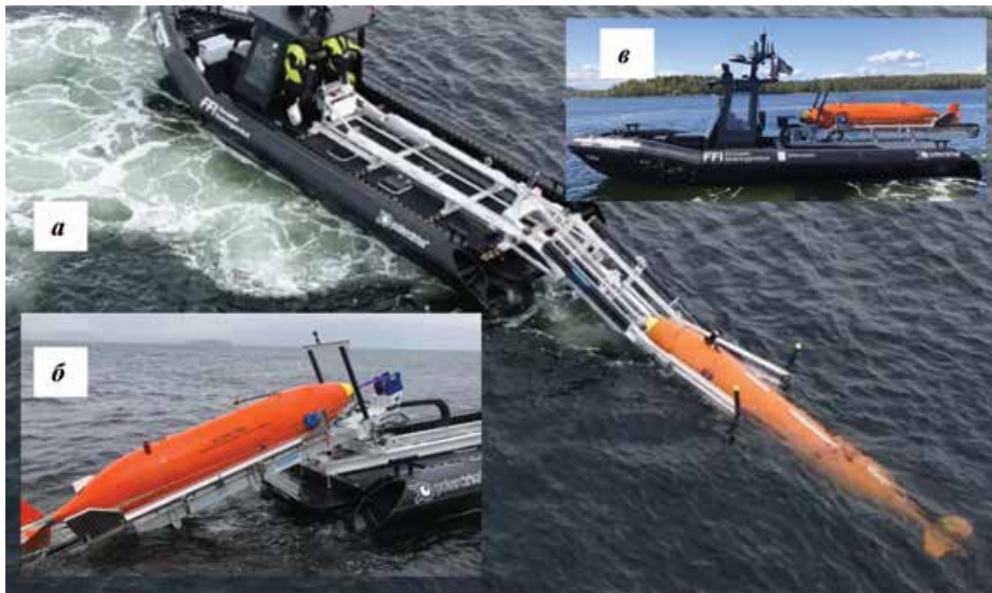
Рис. 4. Схема работы СПУ БЭК Odin: а – прием АНПА HUGIN-1000 в ловитель; б – втягивание АНПА на наклонную рампу; в – транспортировка АНПА в положении «по-походному»
