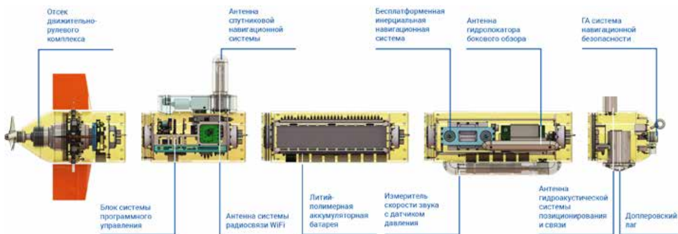
Рис. 3. Состав технических средств и РЭВ поискового АНПА
