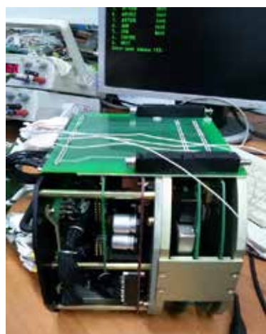
Рис. 10. Отработка блока программного управления ВКА на стенде
