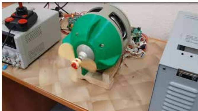
Рис. 7. Отработка движителей с управляемым вектором упора
