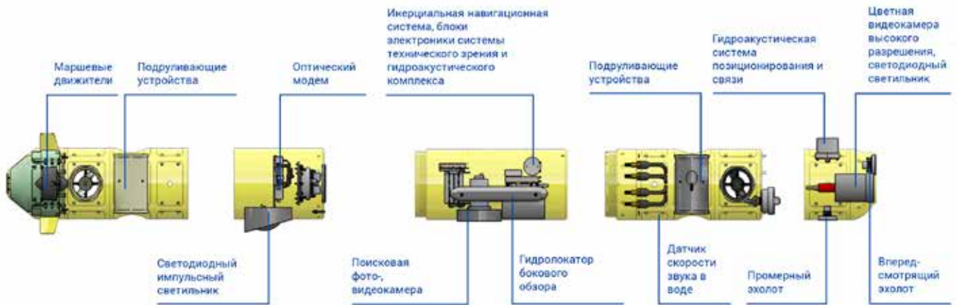
Рис. 4. Модули дополнительного оборудования АНПА
