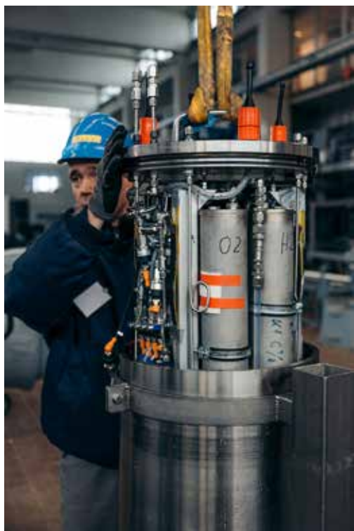
Рис. 5. Вид внутри контейнера топливных элементов, разработанных GEOMAR.
