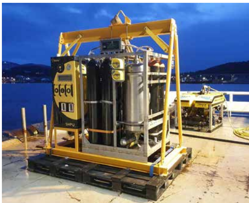
Рис. 4. Подводная зарядная станция Teledyne с подводным гидравлическим насосным агрегатом, разработанным Innova
