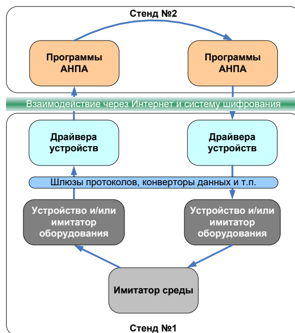
Рис. 3. Взаимодействие программ ядра системы управления с драйверами, устройствами и имитаторами оборудования
