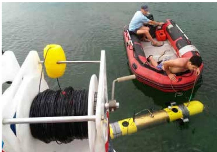
*Рис. 3. Внешний вид ИСБ и фрагменты его использования в режиме телеуправления от судна-носителя через оптоволоконный кабель и поплавком-ретранслятор*
