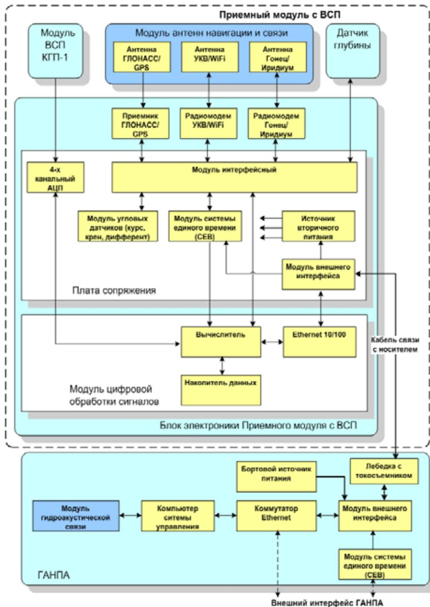
Рис. 7. Структурная схема приемного модуля с векторно-скалярным приемником звука в составе гибридного АНПА
