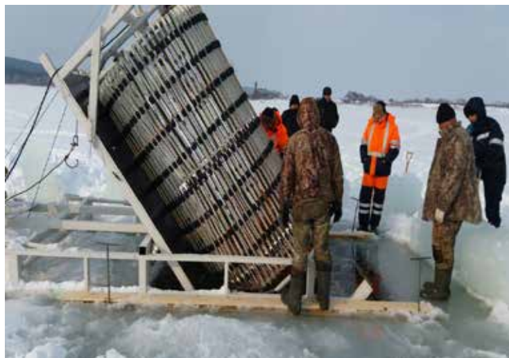
Рис. 2. Пример постановки акустической станции (приемная антенна в транспортном положении) под лед на морском полигоне СКБ САМИ ДВО РАН
