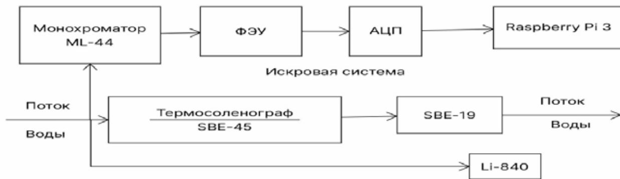
Рис. 1. Схема и изображение проточной системы
