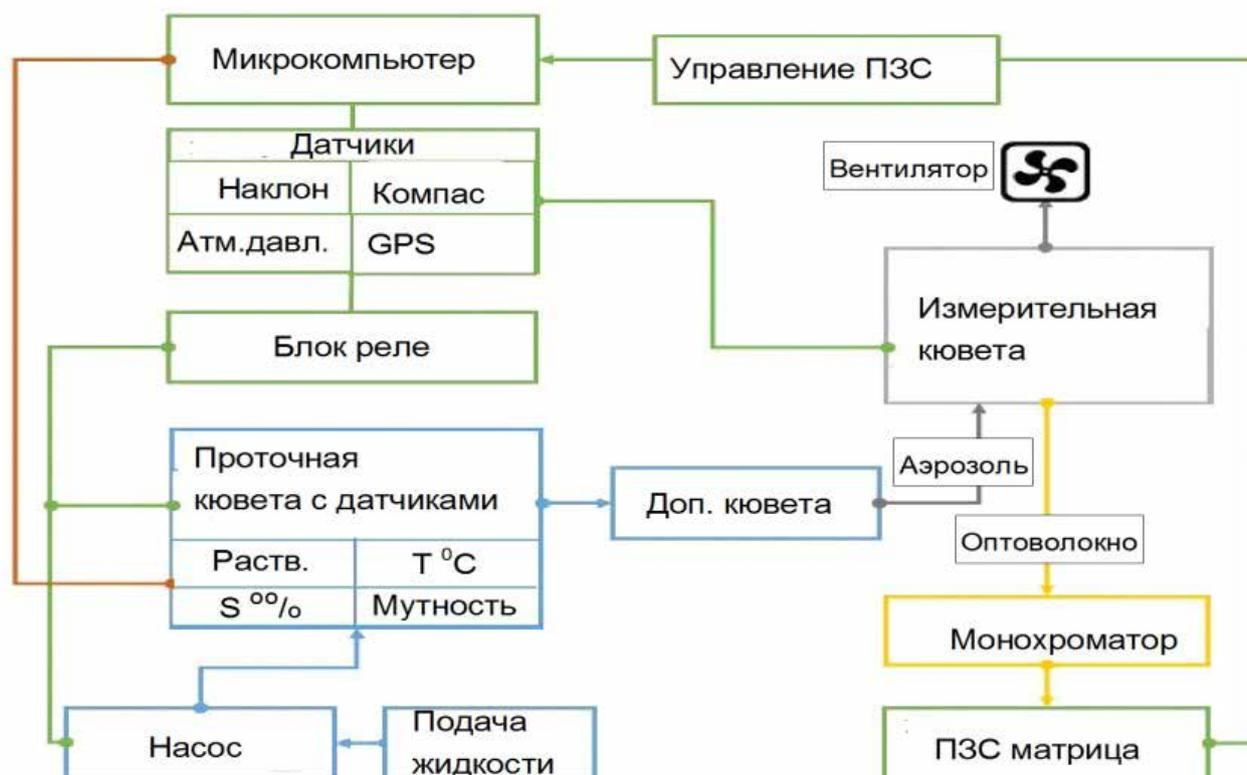
Рис. 2. Блок-схема автоматизированного комплекса для исследования спектральных характеристик морской воды
