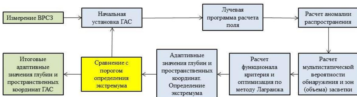
Рис. 3. Алгоритм определения оптимальной глубины установки ГАС
